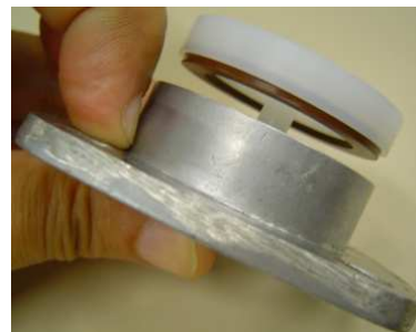
Válvula de Retenção Check - Valve cod. Wayne: BA-4852 rev. A
