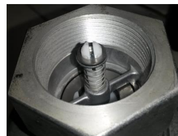
Vista inferior da Check Valve – a desmontagem é efetuada pela parte inferior da entrada do filtro
